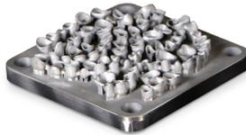
LaserForm CoCr (C) 소재의 부분 영역, 코핑 및 브리지 생산
